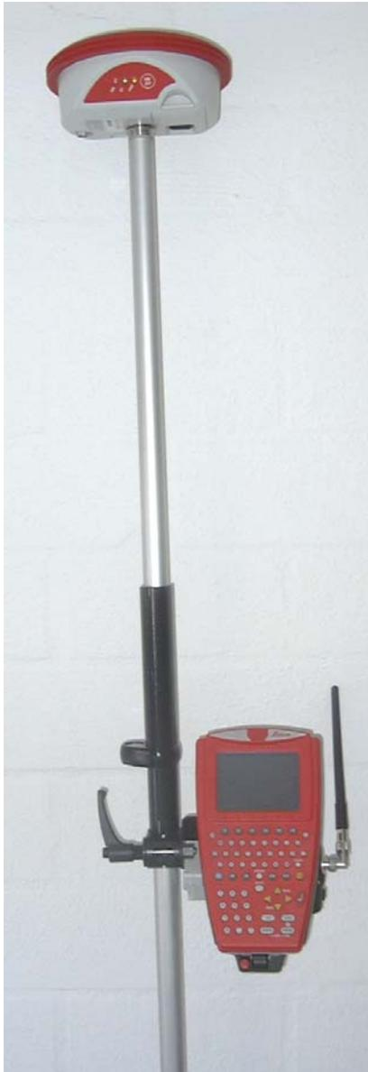
Bild 4-1 Leica GPS900
