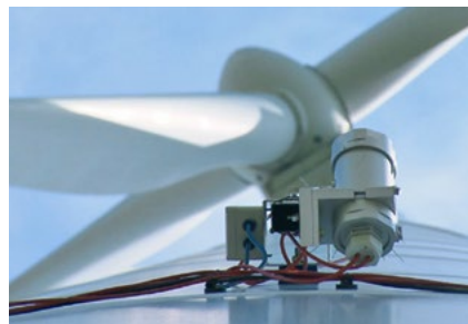
Mögliche Lösung? Windturbinen mit intelligenten Kameras können herannahende Greifvögel erkennen und die Rotorblätter stoppen.
