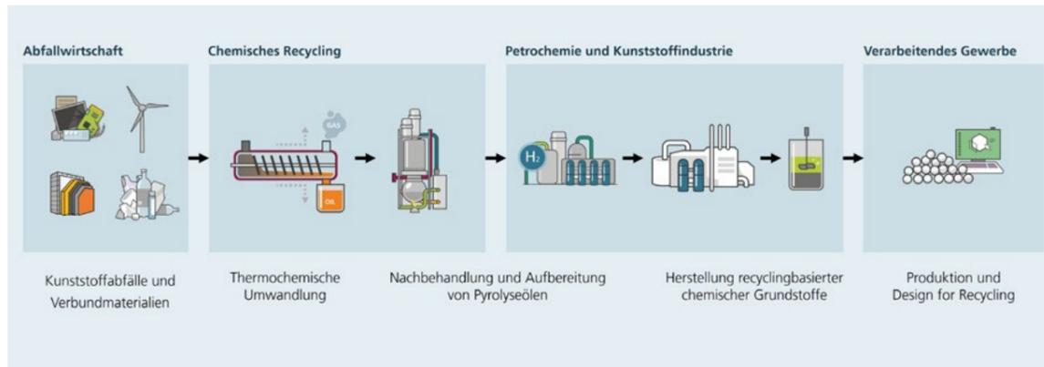
Abbildung 10: Chemisches Recycling<sup>97</sup>; © Fraunhofer UMSICHT
