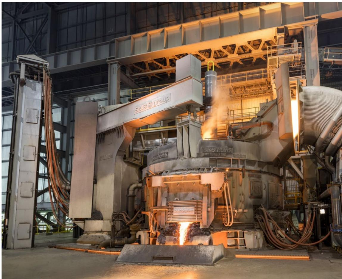
Abbildung 5: Elektrolichtbogenofen (EAF) (Fotos sind illustrativ und bedeuten keine Unterstützung bestimmter Unternehmen oder Standorte); © SMS group GmbH
