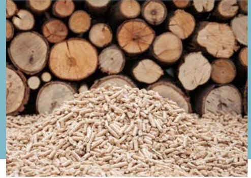
Eine Pelletheizung funktioniert ähnlich wie Öl- und Gasheizungen vollautomatisch. Die aus Holz- und Holzresten bestehenden Pellets führt eine Förderschnecke aus dem Lagerraum oder Silo dem Kessel zur Verbrennung zu. Pellets haben in der Regel eine niedrige Restfeuchte, sind frei von Rinde und verbrennen daher sauberer als Scheitholz.
