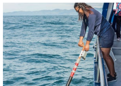
Mit einem Hydrophon werden die Geräusche unter Wasser gemessen.
