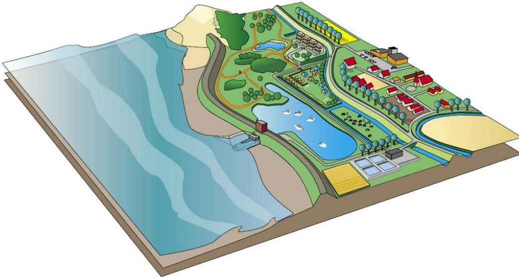
**Abb. 7: Gestaffeltes Küstenschutzsystem: Hauptdeichlinie mit einem Polder und dahinter liegender zweiter Deichlinie.** © van Lint Vormgeving
