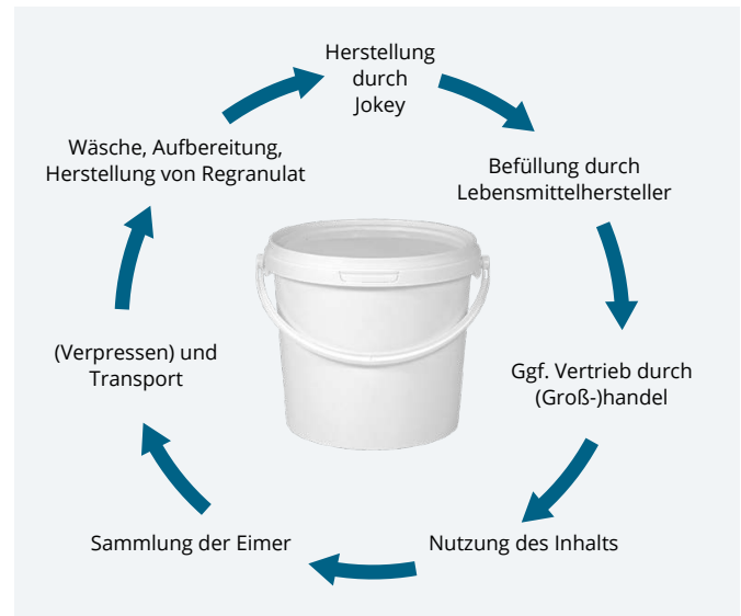
Abb. 7: PP-Stoffkreislauf zwischen Verpackungshersteller, Lebensmittelhersteller, Hotelbetrieb und Recycler
